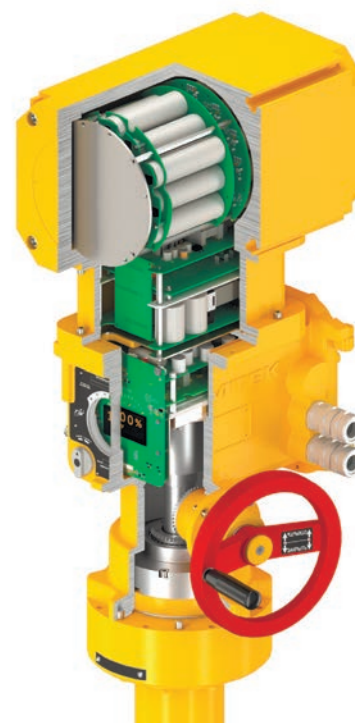
Рис. 2. Конструкция прямоходного электропривода «РэмТЭК» со встроенным накопителем энергии
